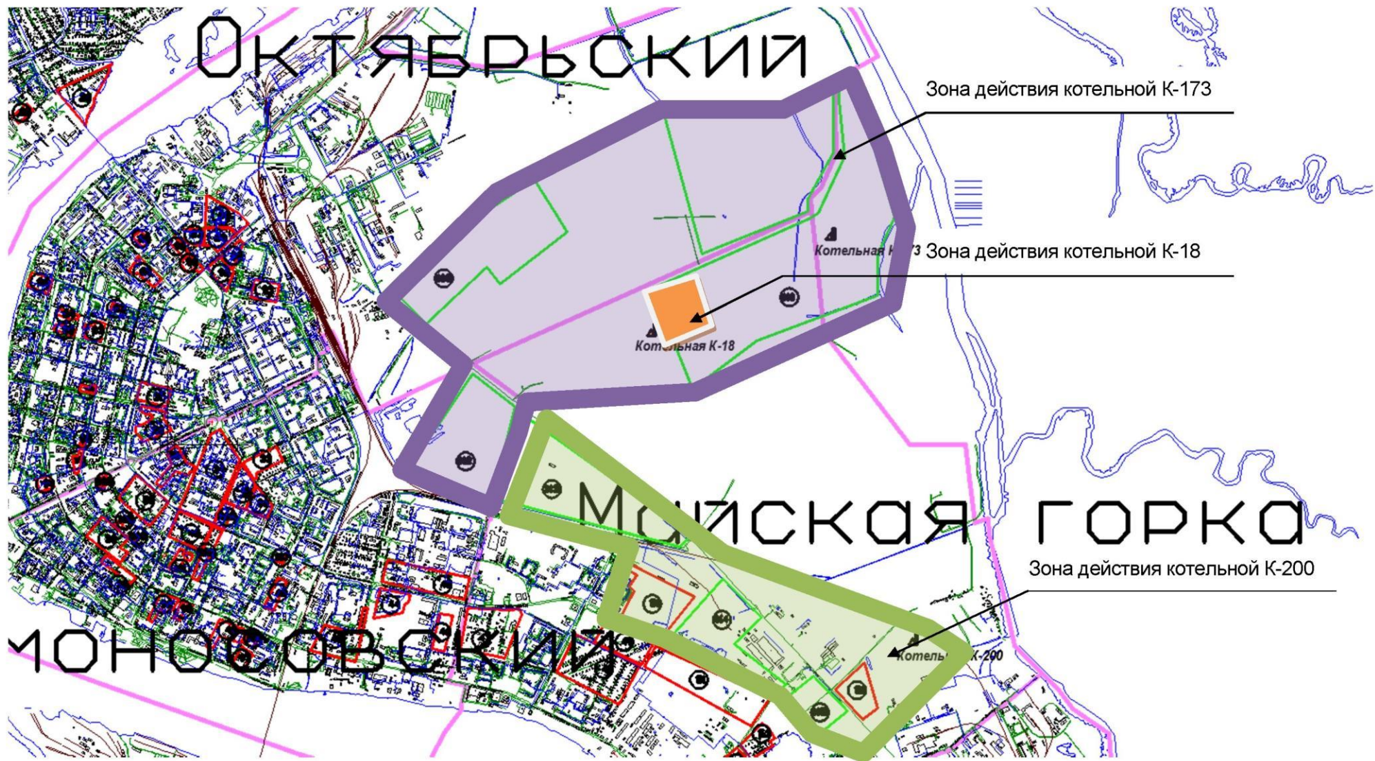
Рисунок 3.1. Предлагаемые зоны деятельности в зонах обслуживания предлагаемых к строительству котельных К-200, К-173, К-18
